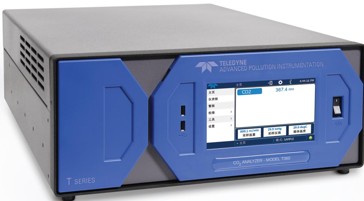
T360型二氧化碳分析仪使用气体滤波相关轮比较红外能量在样品中和参比气体中的吸收状况，然后根据比尔朗伯定律计算得出二氧化碳浓度。
