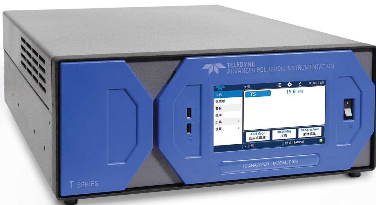
T108型总硫分析仪以测量空气或二氧化碳中的混合硫杂质（总硫）为设计目的，由T100型二氧化硫分析仪修改版（内含特殊软件）和501TS型高温热氧化器组成。
