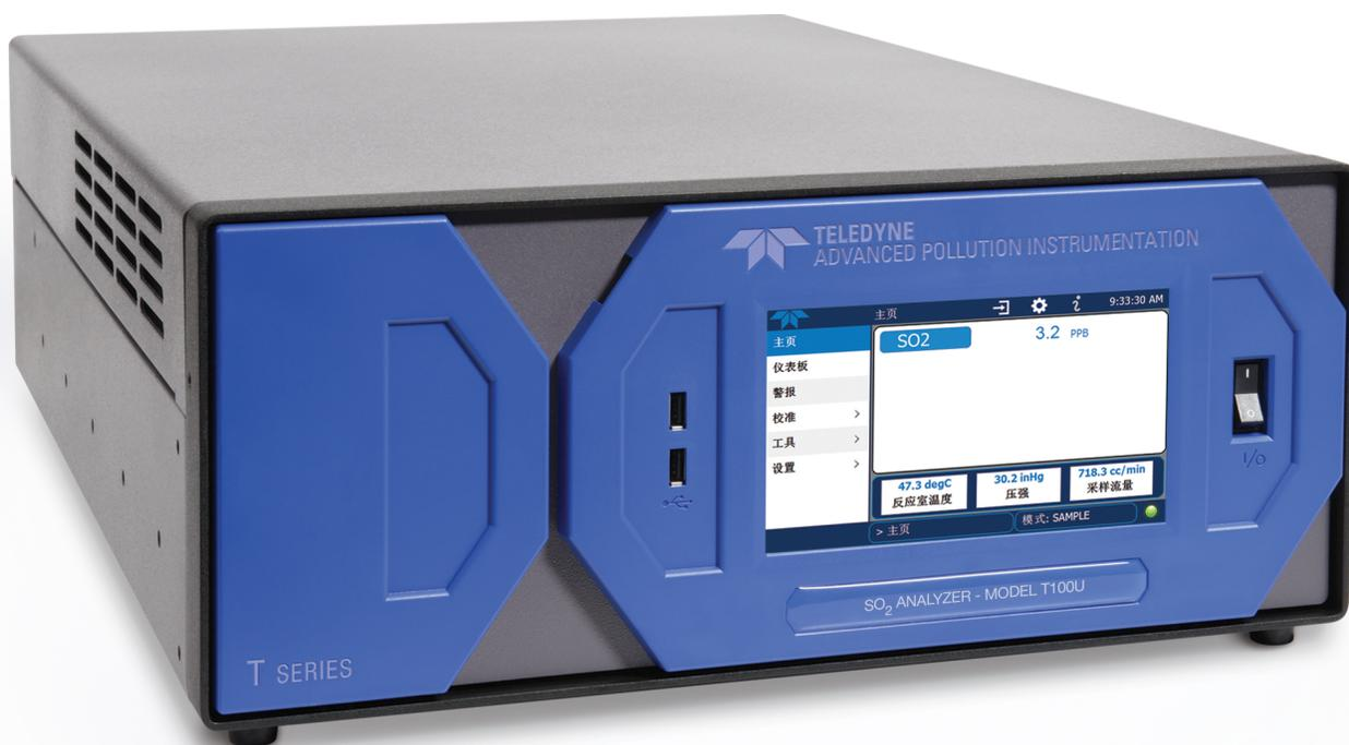
T100U型痕量级紫外荧光法SO<sub>2</sub>分析仪采用通过验证的紫外荧光法原理和先进的电子元件进行低浓度二氧化硫测量。T100U结合了高敏感度和自动量程功能，适用于环境空气质量监测和其他低浓度应用。
