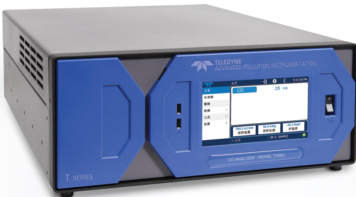
T300U型分析仪使用通过验证的气体滤光相关红外吸收法和先进的电子元件进行低浓度一氧化碳测量。T300U结合了高敏感度和自动量程功能，适用于环境空气质量监测和其他低浓度应用。
