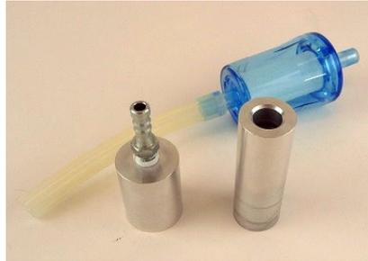
**Figure 4-1. Leak-Check/Flow-Audit Adaptor Kit**
